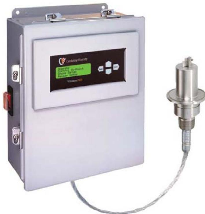
ビスコプロ(VISCOpro) 2000 型粘度計は、メニュー選択式のエレクトロニクスにより PAC 社の高品質なインライン型、インタンク型のセンサーの性能を最大限に引き出し、制御します。高性能でありながら操作の容易なこのモデルは粘度、温度、温度補正付き粘度(TCV)さらにオプションとして密度のデータもディスプレイパネルに表示することができます。計測レンジは工場設定された 13 レンジにより 0.2 ~ 20,000 cP までを高精度にカバーします。
