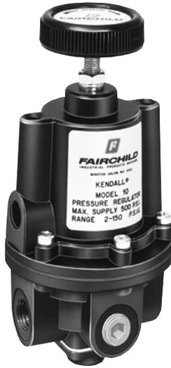
モデル 10 は高い容量と正確なプロセス制御が要求されるアプリケーション用に設計されています。ローリングダイヤフラムを利用するポペットバルブは、さまざまな供給圧力の変化があっても一定の出力圧力を保証します。加減された圧力の安定性はフロー速度に応じてエア供給を調整するアスピレータ チューブを利用して変化する高流量条件下で維持されます。
