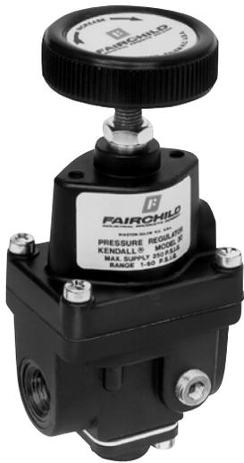
モデル 30 は小さいパッケージで高い容量と正確なプロセス制御が要求されるアプリケーション用に設計されています。ローリングダイヤフラムを利用するポペットバルブは、さまざまな供給圧力の変化があっても一定の出力圧力を保証します。加減された圧力の安定性は流量速度に応じてエア供給を調整するアスピレータ チューブを利用して変化する流量条件下で維持されます。
